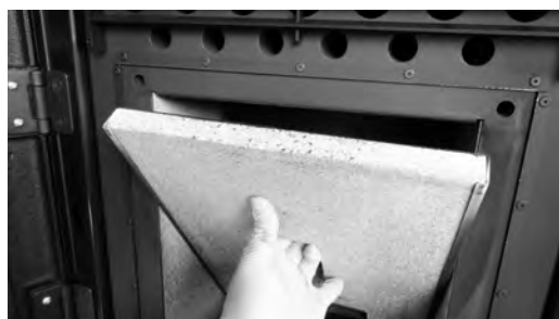
耐火レンガ（背面）の抜き取り
