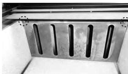
左右 2 箇所のボルトを外します。
